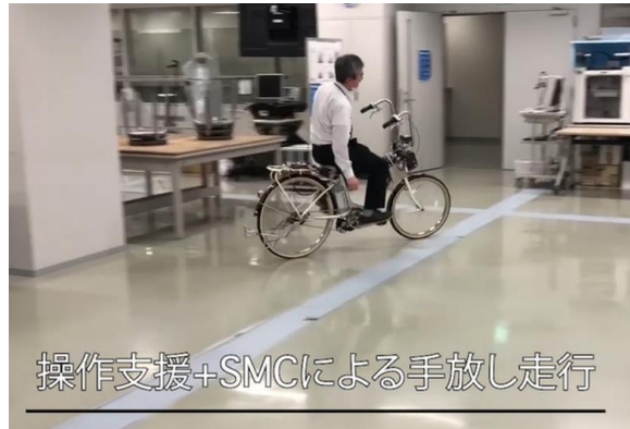
図2 プロトタイプ機による手放し旋回走行 (基礎実験中)
